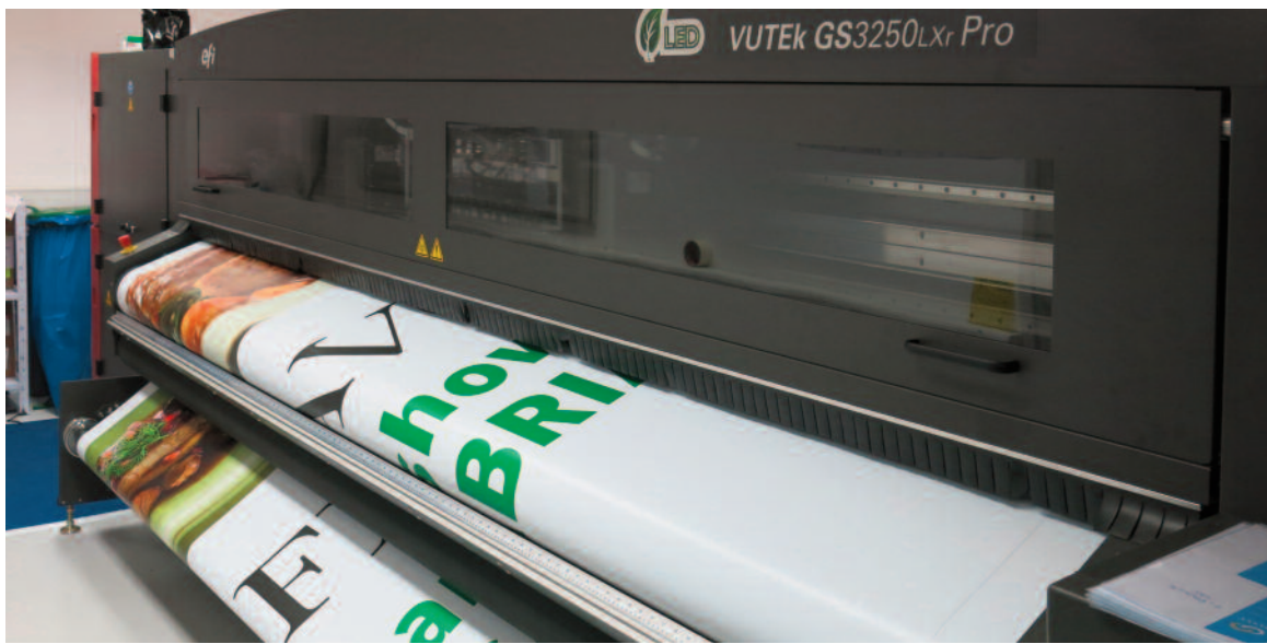
Der EFI Vutek GS3250LXR Pro härtet die UV-Tinten mit LED-Lampen und hat die Druckkapazität bei Wetec verdreifacht.
