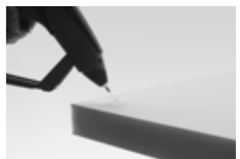
Montage mit Heiß- und Montagekleber
