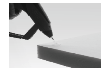
Montage mit Heiß- und Montagekleber
